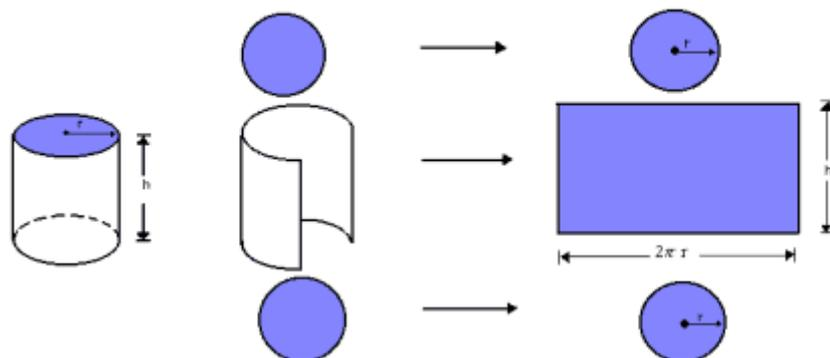
Assim, a área lateral do cilindro reto cuja altura é  $h$  e cujos raios dos círculos das bases são  $r$  é um retângulo de dimensões  $2\pi r$  e  $h$ :
